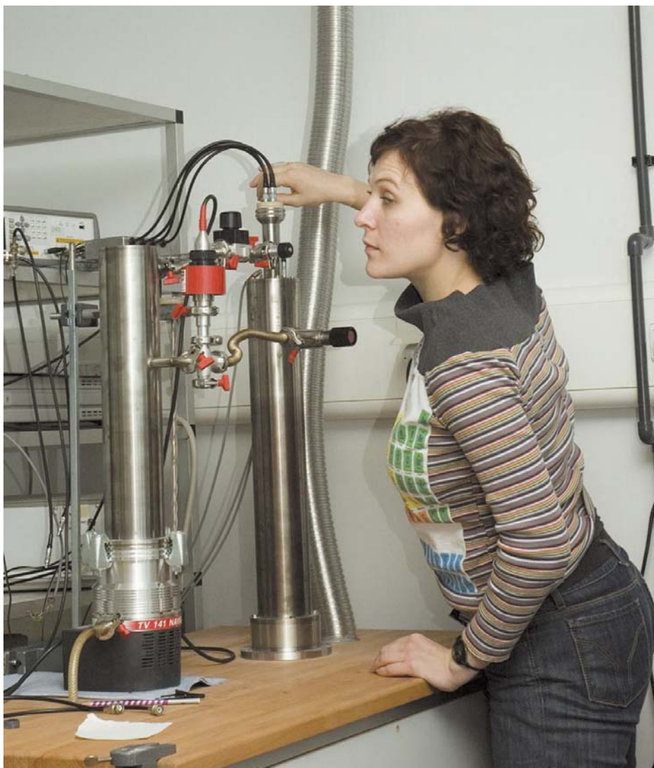
5. Et eksempel på laboratorieopstillingen ved grundforskningscentret Glas og Tid hvor et større "køleskab" kontrollerer temperaturen med en nøjagtighed på mindre end en tusindedel af en grad, om nødvendigt over flere uger. Avancerede elektriske måleinstrumenter gør det muligt (her for adjunkt Kristine Niss) at måle forskellige egenskaber af de seje væsker anbragt i køleskabet, vha. fx instrumenterne vist i fig. 3 & 4. (E. Søgaard)
