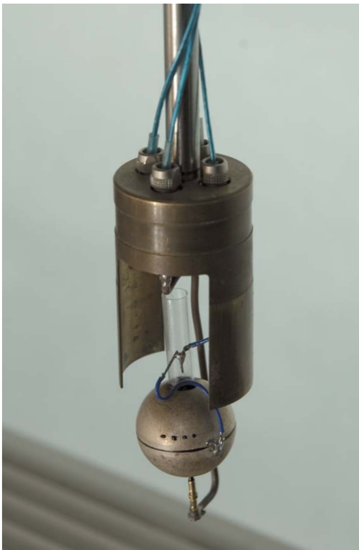
3. Et kugleskalsinstrument udviklet ved grundforskningcentret Glas og Tid til måling af en meget sej væskes sammentrykkelighed. Trykker man langsomt er det noget nemmere end hvis man trykker hurtigt. Sammentrykningen kan kontrolleres elektrisk fordi kugleskallerne er såkaldte piezo-keramikker. (E. Søgaard)
