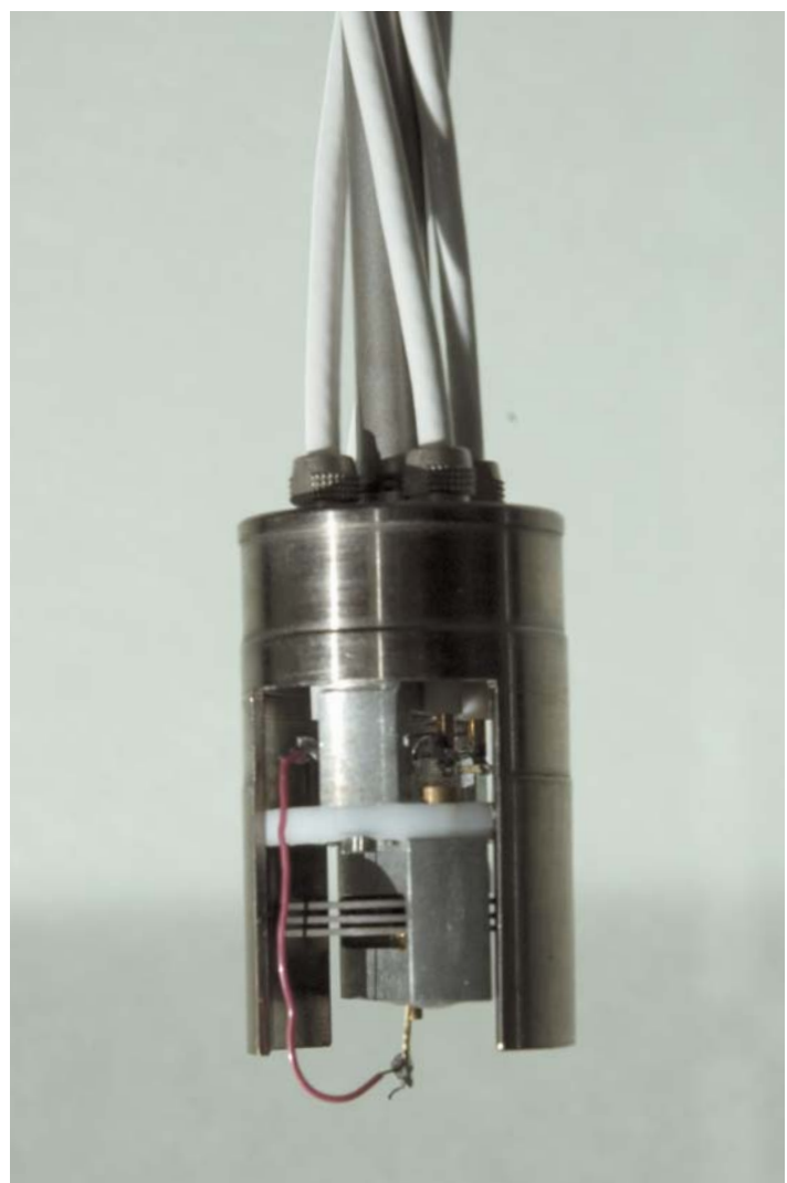
4. Et instrument udviklet ved grundforskningcentret Glas og Tid til måling af en meget sej væskes viskositet. Væsken sprøjtes ind i de to mellemrum mellem de tre skiver ved højere temperaturer hvor den ikke er sejtflydende. Flydning på nanometerskala kan kontrolleres elektrisk fordi skiverne er såkaldte piezo-keramikker. (E. Søgaard)
