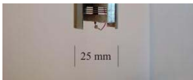
Denne såkaldte 'shear transducer' bruges til at få en lille del af en sej væske til at flyde, så den kan bruges til målinger. Den er udviklet på RUC og findes ingen andre steder i verden. (Foto: Institut for Natur, Systemer og Modeller, RUC)
